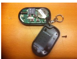
3: Öppna locket med en vanlig skruvmejsel som förs in i skåran. Vicka försiktigt och följ med runt så locket öppnas.
