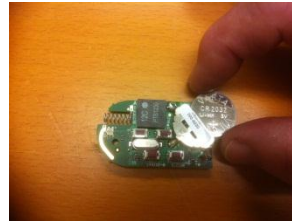
4: Tag ur det gamla batteriet och ersätt med ett nytt. Sätt tillbaka locket. Var uppmärksam på att gummiplattan med symboler kommer rätt..
