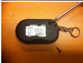
2: Lossa skruven med stjärnskruvmejsel.
