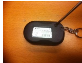
5: Sätt tillbaka skruv och prova fjärrkontrollen.
